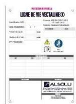
Para cada línea de vida VECTALINE® montada, se proporciona una placa de información para indicar las características del sistema instalado e identificar las empresas (instalador, verificador, distribuidor y fabricante).
