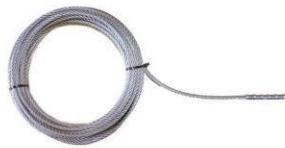
La terminación en inox 316 está engastada en fabrica en el cable o en obra con una crimpadora adaptada. El cable (Ø8 mm 7x19) en inox 316 está disponible en larguras de 11 a 61 m engastado. Consultarnos para larguras de cable superior.
